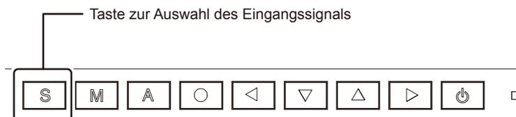
Wechseln Sie durch Drücken der Taste **S** das Eingangssignal. Das Eingangssignal wechselt bei jedem Drücken der Taste **S**. Wird das Eingangssignal gewechselt, erscheint für 2 Sekunden der aktive Signaltyp (Analog oder Digital) oben rechts im Bildschirm.
