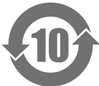
本标识根据「电器电子产品有害物质限制使用管理办法」，适用于在中华人民共和国销售的电器电子产品。标识中央的数字为环保使用期限的年数。只要您遵守该产品相关的安全及使用注意事项，在自制造日起算的年限内，不会产生对环境污染或人体及财产的影响。上述标识粘贴在机器背面。
