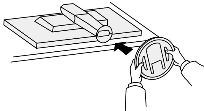
**3. Drehen Sie den Standfuß im Uhrzeigersinn, bis er mit einem Klicken einrastet.**
