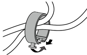
3. Befestigen Sie den geschlossenen Kabelhalter am Standfuß.
