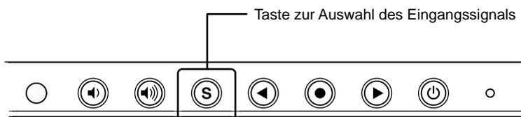
Wechseln Sie mit der Taste (S) das Eingangssignal. Das Eingangssignal wechselt bei jedem Drücken der Taste (S). Wird das Eingangssignal gewechselt, erscheint für 2 Sekunden der aktive Signaltyp (Analog oder Digital) oben rechts im Bildschirm.
