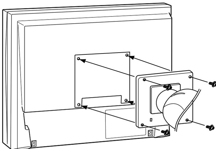
Vis de fixation : M4 x 12 mm x 4 pièces
