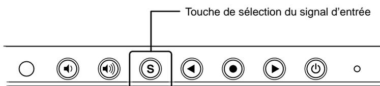
Changez le signal d'entrée en appuyant sur **(S)**. Le signal d'entrée commute chaque fois que vous appuyez sur **(S)**. Lorsque le signal est commuté, le type de signal actif (analogique ou numérique) s'affiche pendant deux secondes dans le coin supérieur droit de l'écran.
